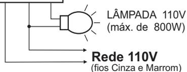
OBS.: Ao ser alimentado, o IP110 necessita de 40 segundos para sua estabilização. Durante este período, sua saída permanece acionada.
